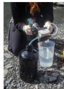
Feldarbeit zur eDNA-Probenahme: Wasser wird sorgfältig gefiltert, um genetische Spuren aquatischer Organismen zu erfassen
