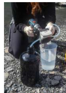
Prélèvement d'ADNe sur le terrain: il faut filtrer l'eau avec soin pour préserver les traces génétiques d'organismes aquatiques.
